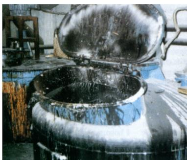
Figura 4.3 - Esempio di sorgente di emissione di primo grado. Apertura per il caricamento di un liquido infiammabile (Rivista UNAE)
