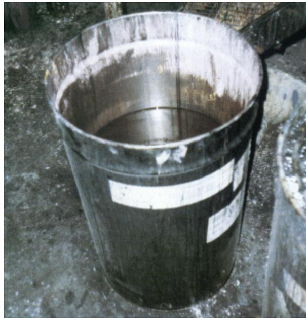
Figura 4.2 - Esempio di sorgente di emissione di grado continuo. Superficie di liquido infiammabile esposta direttamente all'atmosfera (Rivista UNAE)
