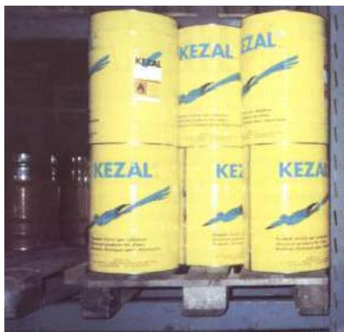
Figura 4.5 - Esempio di ciò che non è considerato sorgente di emissione. Contenitori di vernici con coperchi sigillati (Ditta Kezal - Rivista UNAE)
