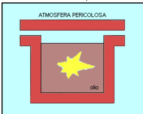
Figura 13.1 - Schematizzazione del modo di protezione Ex-o
