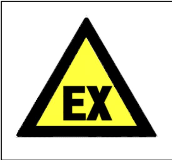
Figura 6 - Cartello che identifica un'area in cui può formarsi un'atmosfera esplosiva
